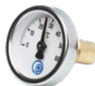
Termómetro con escala 0-60°C, con entrada Ø 3/8" macho
